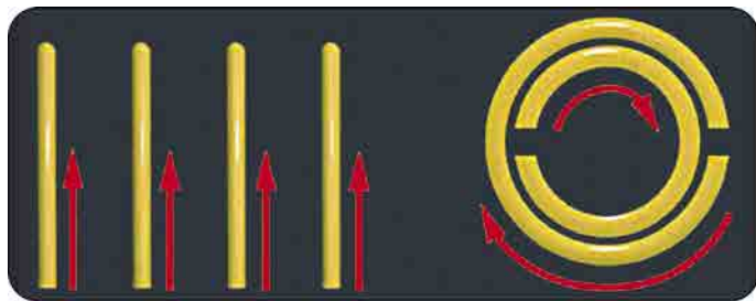
Рис. 8. Механизм возбуждения токов в метаматериале под действием внешней электромагнитной волны: в матрице проводников электрическое поле волны возбуждает линейные токи (красные стрелки), в кольцах с разрезами (резонаторах) магнитное поле возбуждает круговые токи.
