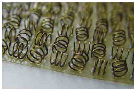
Рис. 9. Экспериментальный образец метаматериала, изготовленного из спиралей.
